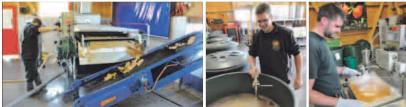
Mit der Kleinpresse wird das Obst vollständig ausgepresst. Danach wird der frische Most in Fässern für ein paar Ruhestunden gelagert und schliesslich pasteurisiert und abgepackt. Bilder Peter Soland
